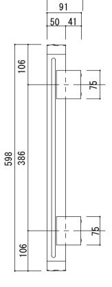
フ<sup>\*</sup>ラケット6-E 切欠寸法 W278×H600×D95(土<sup>2</sup><sub>0</sub>)
